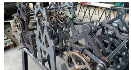
Montage des Uhrwerks und anschliessende Inbetriebnahme
